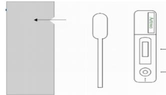
2. Sostener el gotero de muestra verticalmente y añadir tres gotas completas (120 µl) de muestra sin burbujas de aire en el pocillo de muestra que está marcado con una flecha en el dispositivo de prueba.
